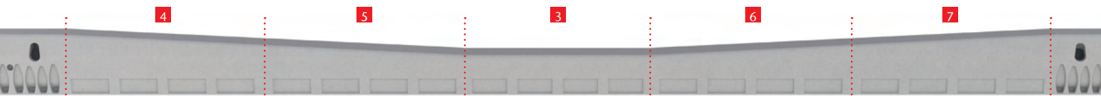
Sænkning med 5 % hældning (2-delt)
